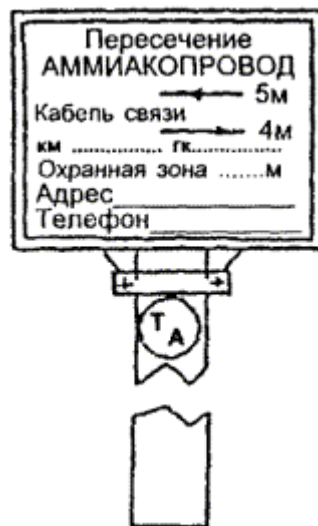
Знак пересечения магистрального аммиакапровода с трубопроводами
