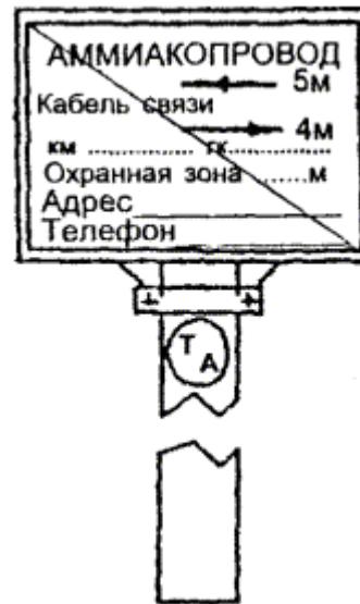
Знак поворота магистрального аммиакопровода направо
