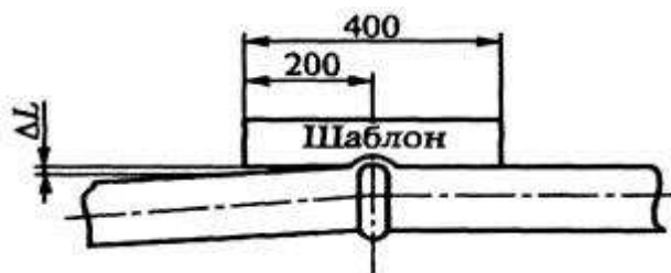
Рисунок 11. Схема определения отклонения от прямолинейности оси трубы.
