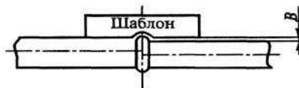
Рисунок 10. Схема определения смещения кромок стыкуемых труб.
