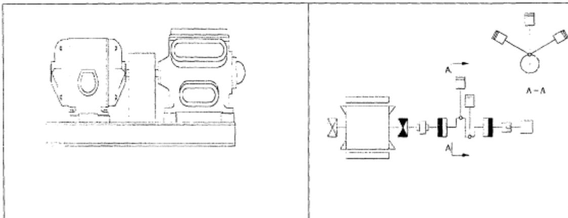
Схемы измерения вибрации
